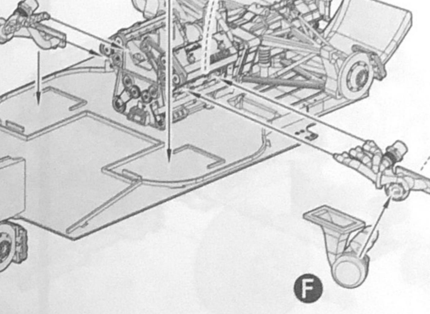
エンジン・車体に組み付けながら、接着します。
