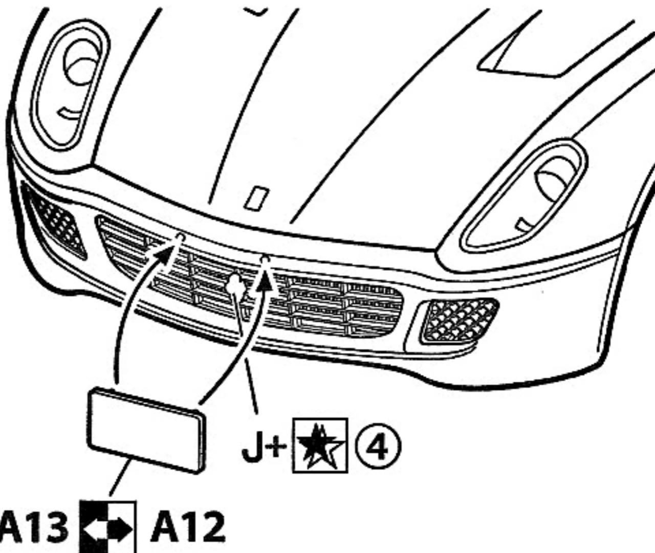
J部品の接着には合成ゴム系、溶剤系接着剤または、エポキシ系樹脂系・化学反応系接着剤を使用してください。
