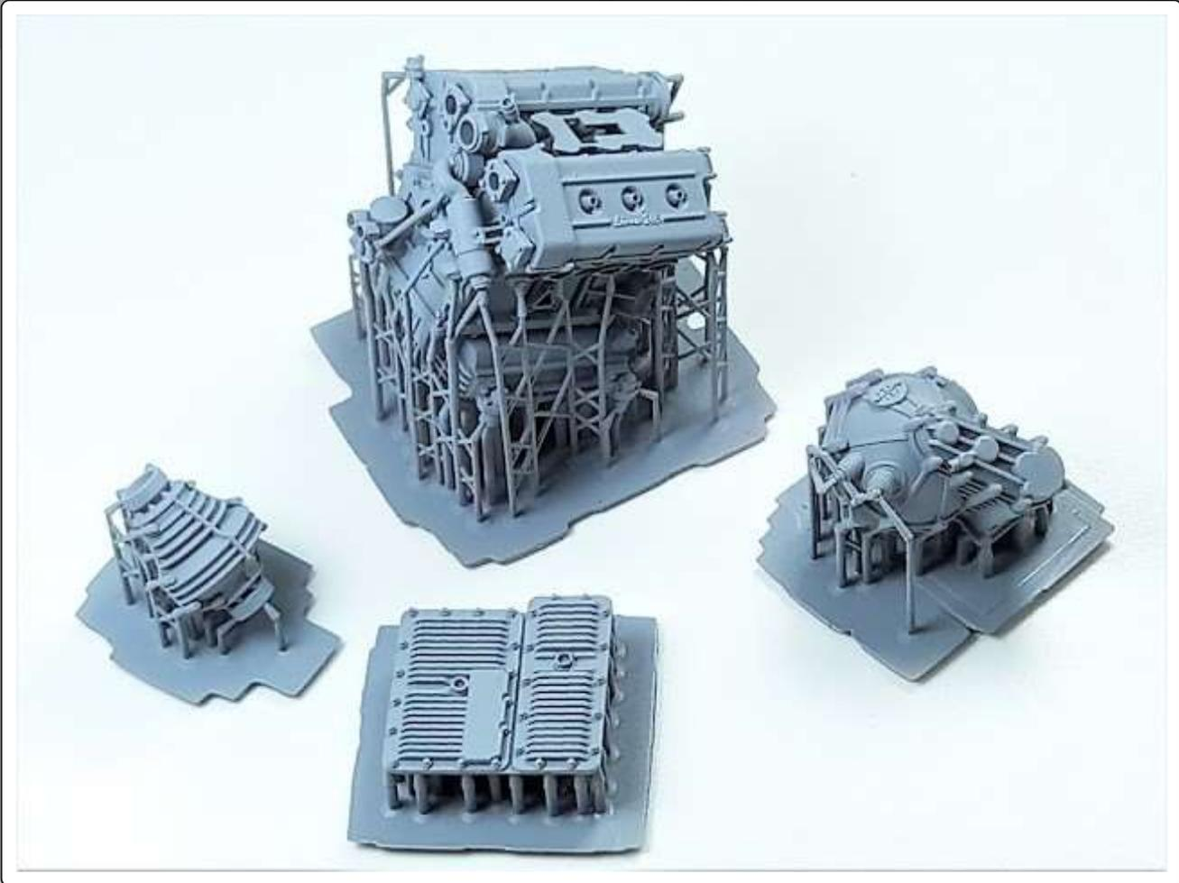
Ecco come si presentano le parti una volta rimossi i supporti. Levigate bene per rimuovere i segni rimasti. Tutte le parti poi hanno degli incastri per il giusto posizionamento . Se necessario stuccate specialmente nella zona di attacco della colonna motore.
