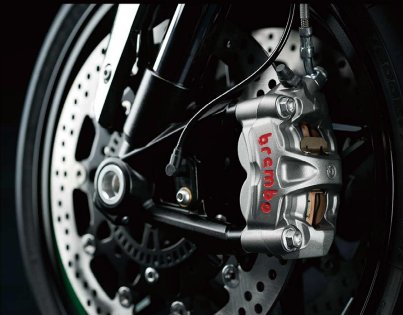
一双巨大的直径330mm、厚度5.5mm的BREMBO半浮盘可以提供卓越的制动力。盘外缘中心运行的凹槽可以增加较大的散热表面积。双重径向铸铝实心卡钳紧扣前盘。对抗4-活塞卡钳的高度刚性可以产生精湛的制动力。BREMBO径向泵主缸在被运往川崎之前会得到额外的注意。每部分都是被检查和调整过的以便消除任何无效的冲程。双重径向铸铝实心卡钳紧扣前盘。对抗4-活塞卡钳的高度刚性可以产生精湛的制动力。
