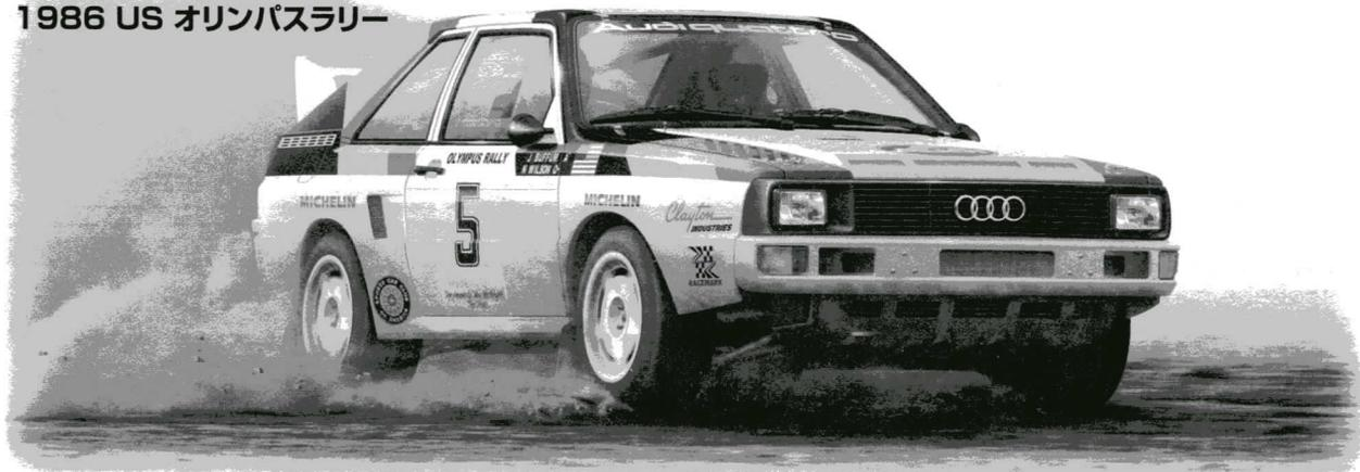
1981年1月の世界ラリー選手権第1戦、モンテカルロラリーにアウディは2台のワークスマシンを送り込みました。そのマシンはWRCでは初となるフルタイム4WDを採用していたのです。それまで複雑なメカニズムと重量増加が避けられない4WDは高速走行には不向きとされてきました。その中でハイスピード4WDという世界に挑戦したのがアウディだったのです。1980年3月のジュネーブショーで4WDの乗用車、アウディ・クワトロを発表。センターデフを装備したフルタイムの4WDシステムは4輪に常に最適なパワーを分配し、最大限のグリップ力を提供。フロントに搭載した直列5気筒2144ccターボチャージャー付エンジンが生み出すパワーを路面に確実に伝え、安定した走りを生み出したのです。当時の規定に沿ったグループ4仕様のラリーカーを開発すると1981年にWRCの舞台に打って出ます。第2戦スウェーディッシュラリーで初優勝。翌1982年シーズンにはコンストラクターズチャンピオン、83年にはドライバーズチャンピオンを獲得して見せたのです。
