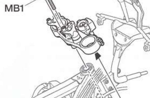
★ステアリングの動きはビスの締め込みで調整します。
