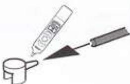
★パイプの取り付けがゆるい場合は、瞬間接着剤を使用して固定します。
